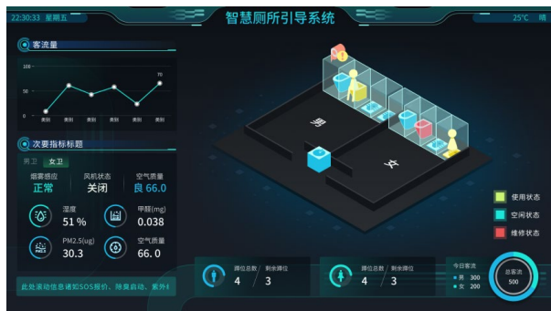
图2 智慧厕所引导大屏，可实时更新坑位余量、空气质量、耗材余度，一屏掌握厕位状态
